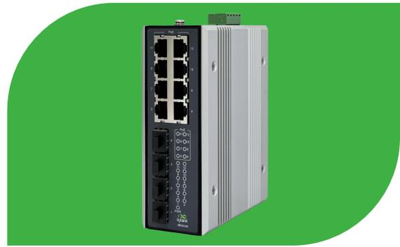
ISE系列非网管工业交换机专为电力、交通、工业控制及其他严酷工业环境设计。其设计融合了宽温、宽压特性以及受保护的工业电路。该系列产品支持即插即用，可快速便捷地进行部署。此外，ISE非网管工业交换机采用48~54VDC冗余双输入电源，具备坚固的铝合金外壳，符合IP40防护等级，并通过EMI/EMC高等级测试。
