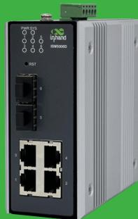
ISM系列WEB网管工业交换机专为电力、交通、工业控制及其他严酷工业环境设计。其设计融合了宽温、宽压特性以及受保护的工业电路。此外，ISM系列采用9.6~60VDC和18~30VAC冗余双输入电源，拥有先进且全面的网络功能，支持STP/RSTP环网冗余协议，为用户构建复杂的工业以太网通信系统提供灵活的选择。
