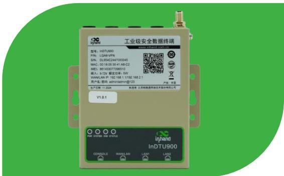
InDTU954C系列产品作为配电终端安全防护设备（简称配电终端安全模块），采用全国产化硬件平台，支持5G/4G/3G/2G蜂窝网络和有线接入，支持国密，设备小巧，可安装在配电室、配电柜、架空线等各类配电终端箱体中，提供对配电终端的数据保护，满足配电网数据安全实时传输的要求，无缝对接各种电力主站平台。
