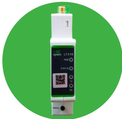
LT310系列是一款基于 LoRa 无线技术的数据传输终端，支持LoRa、FSK、GFSK等多种调制方式，结合频谱扩宽处理技术，解决了小数据量在复杂环境中的远距离通信问题。工作频段470MHz~510MHz，支持内嵌自组网透明传输协议，支持一键组网。
