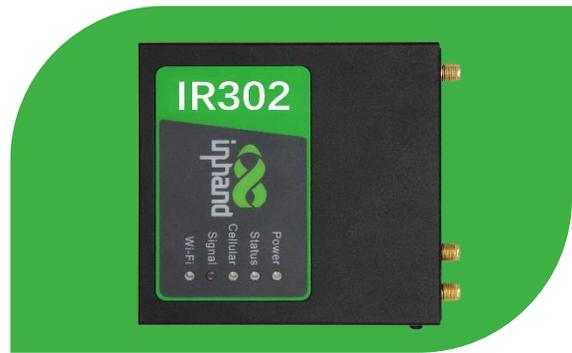
InRouter302 (简称IR302) 系列产品是一款集成了4G网络、Wi-Fi和虚拟专用网等多种技术的物联网无线路由器, 提供简单、可靠和安全的互联网连接。产品设计考虑到无人值守现场通信的要求, 采用了软、硬件看门狗和多级链路检测机制, 以确保通信的稳定性和可靠性。同时, IR302系列产品支持映翰通的Device Manager“设备云”管理平台, 使用户能够实现远程智能化设备管理。IR302系列产品适用于各种工业和商业物联网应用, 为数字化物联网提供了高效和可靠的解决方案。
